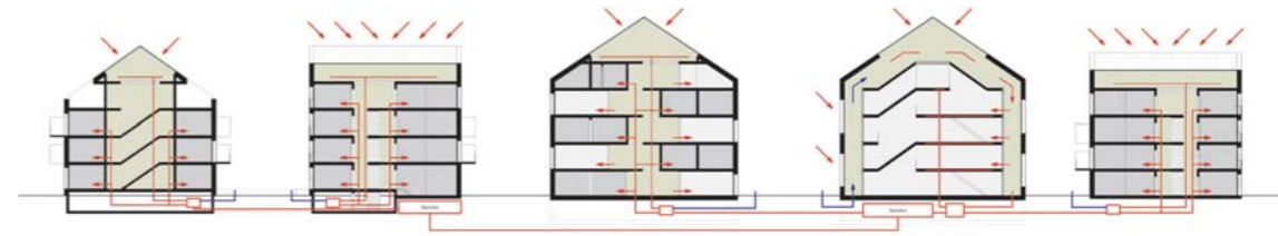
Energetisches Quartierskonzept im Neubau: „Zeppelin-Hof“ in Neuwied, Verbundschema Bauherr: Gemeindliche Siedlungs-Gesellschaft Neuwied mbH
