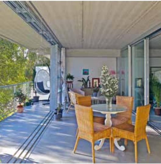
ture extérieure, cet espace peut soit être transformé en loggia ouverte, soit être fermé par des panneaux coulissants en polycarbonate. En hiver, il sert de tampon thermique sans assombrir l'intérieur.
